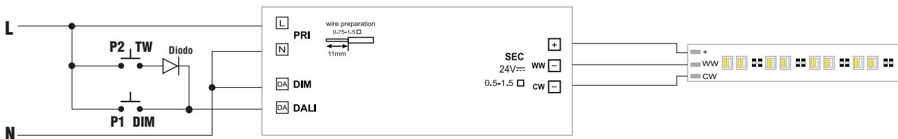
Collegare un DIODO VRated  $\geq$  280Vrms (1N4004 ÷ 1N4007) in serie al PULSANTE P2.
