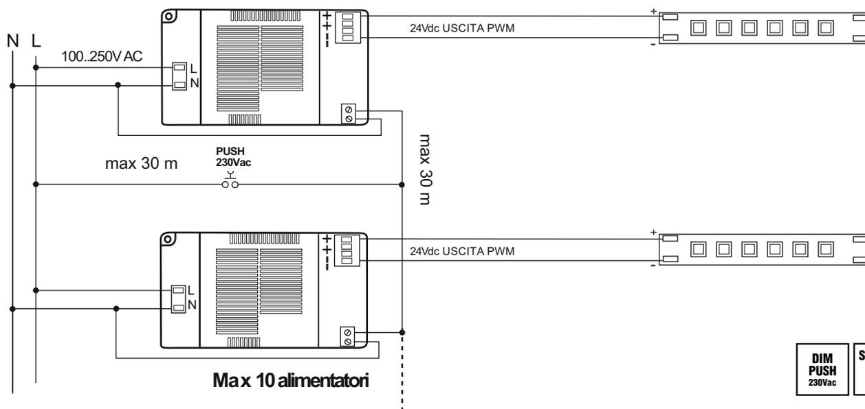
La pressione veloce del pulsante permette l'accensione e lo spegnimento; la pressione prolungata permette la regolazione. In caso di mancanza di rete o interruttore sul lato primario, per l'accensione successiva, la centralina mantiene l'ultimo livello memorizzato (memoria di stato).
