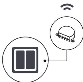
Collega il dispositivo MCU-S2/ONE a uno o a due pulsanti a parete e connessi al router via Wi-Fi
