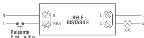
Collegamento del Pulsante sulla FASE Push-button connection on the LINE
