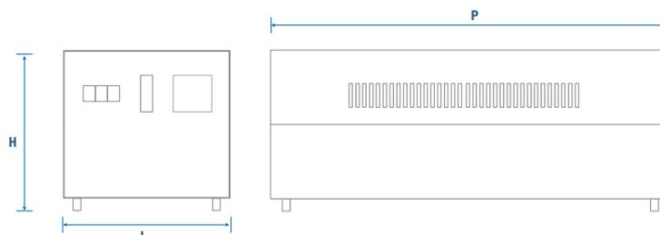
Fino a 2000 VA di potenza viene fornito con cordone e spina in ingresso e uscita con presa Shuko ,per potenza maggiori viene fornito con morsetteria protetta. Protezione in ingresso con fusibili.
